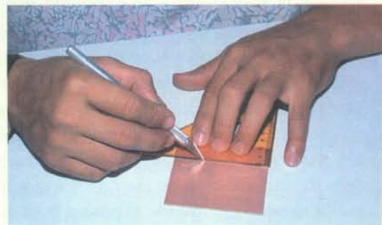
Figuras 5.20 y 5.21. Cortando la lámina sin procesar
